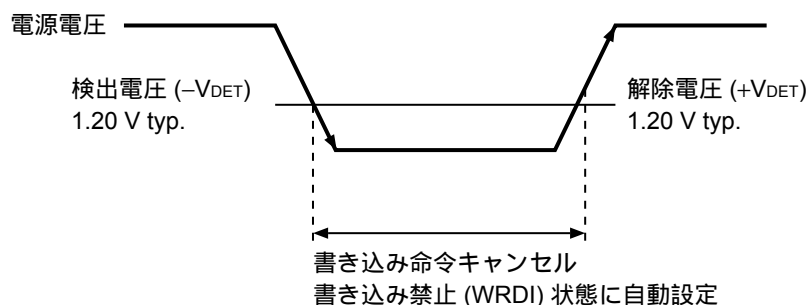
図 21 低電源電圧時の動作 (S-25A080B/160B/320B)
